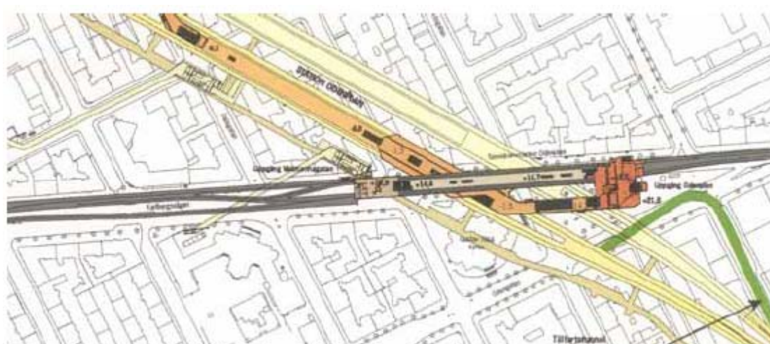
Fig. Citybanan med dubbla spårstunnelar under Odenplan.
