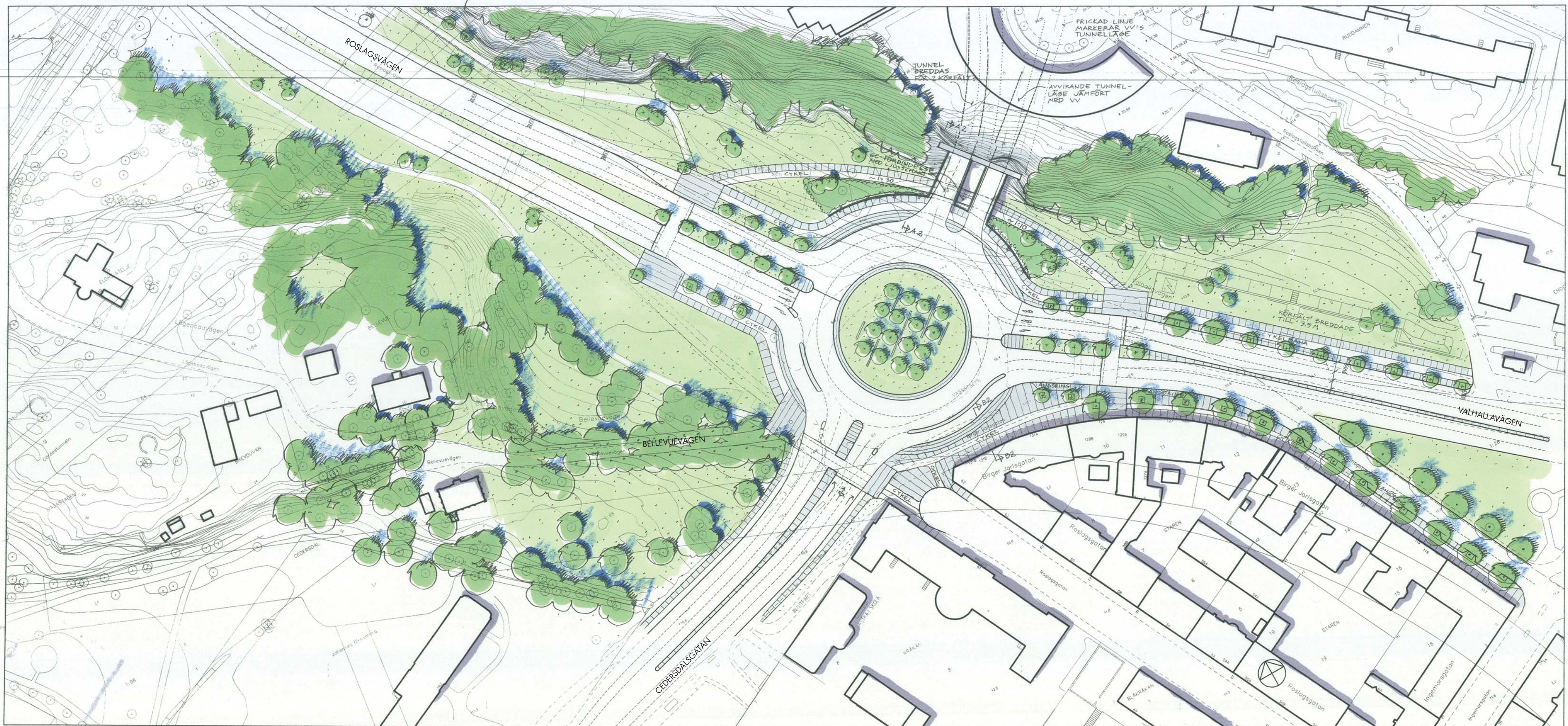
ROSLAGSTULL • ALTERNATIV B1 • RONDELL MED SIGNALREGLERING • AVVIKANDE TUNNEL-LÄGE SKALA 1:500 (A11) 1:1000 (A31) 2008-10-27 TYRÉNS AB
