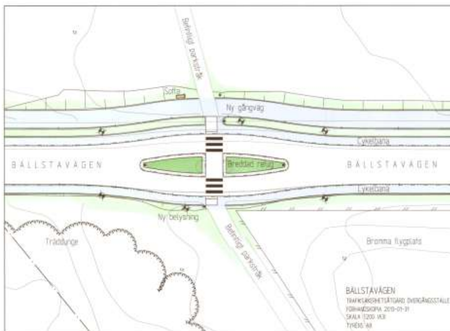
Figur 8. Förslag till utformning av övergångsstället vid flygrakan
