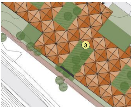
Figur 4.2 Bullerplank (svart tjock linje) – för att klara riktvärden i punkt 3.
