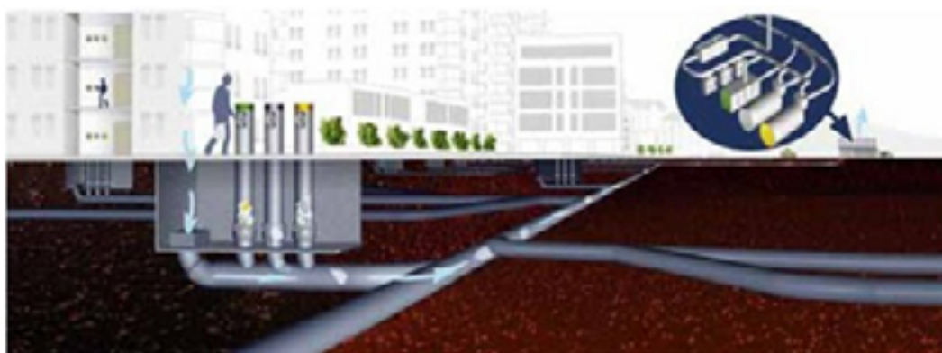
Bild 12.5: Envac, principskiss, stationär sopsug.
