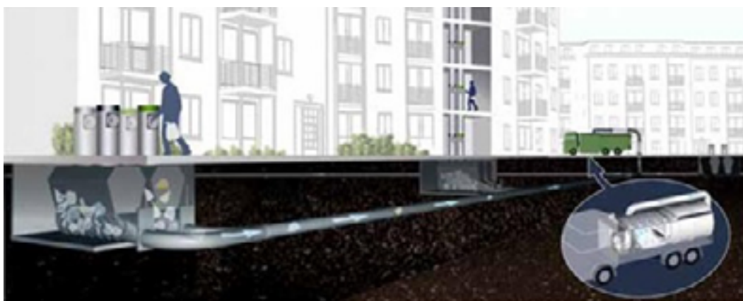
Bild 12.5: Envac, principskiss, mobil sopsug.
