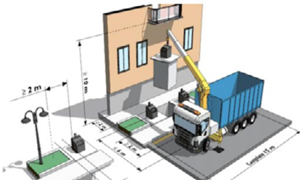
Geometrikrav för tömning av underjordsbehållare (illustration, Stockholms stad).
