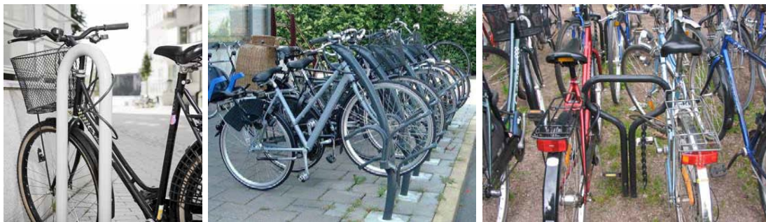
Figur 7: Exempel på cykelställ med ramlås, som är den tryggaste varianten av cykelställ utomhus. Källa: Trafikverket
