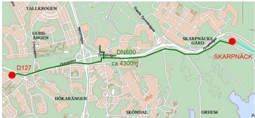
Figur 2, Fortums planerade dragning ny fjärrvärmeledning
