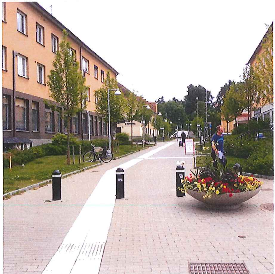
Samma vy efter renoveringen. Ledstråket löper över hela torget och underlättar för personer med synnedsättning att orientera sig.
