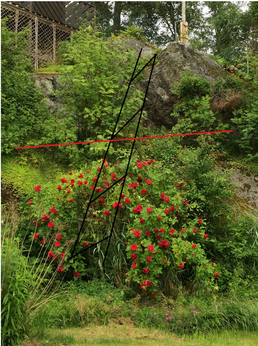
Figur 2. Bergslänten med potentiell svaghetszon i svart och sprickzon i rött
