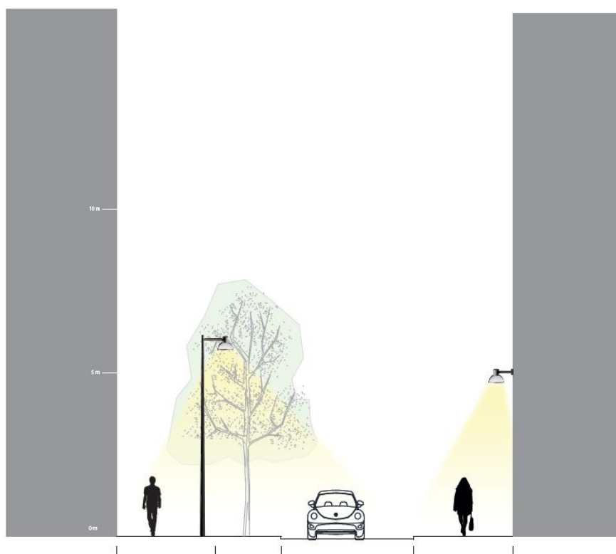
Illustration över gårdsgatan som är 12 meter bred. Till höger i bild ser man armaturen som är fäst på fasad.
