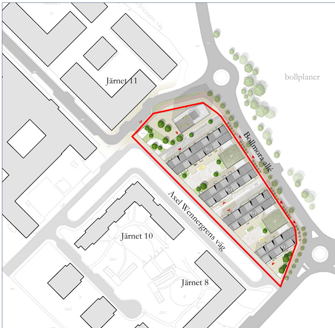
Illustrationsplan. Röttmarkerat område utgör detaljplanen för Järnet 7. Fastigheten är uppdelat i två mindre byggnadskvarter med en passage emellan samt ett punkthus.
