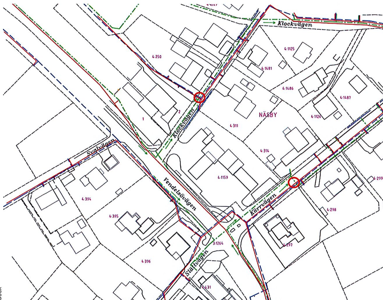
Figur 9. Ledningskarta över området. Dagvattenledningar är streckade gröna, spillvatten är streckade röda och vattenledningar är streckade blå. Heldragna blå linjer är diken längs med Klockvägen. Gröna pilar visar flödesriktningen i ledningssystemet. Befintliga anslutningspunkter för fastigheter som ingår i Abacus område är markerade med röd ring.
