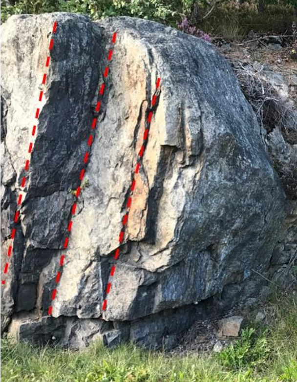
Figur 7: Kartering 5 – Sprickgrupp i foliationsriktning (70/75)
