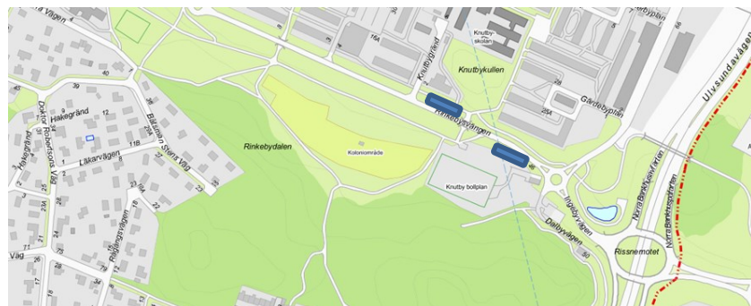
Figur 10 Hållplatser längs Rinkebysvängen förlängs och tillgänglighetsanpassas. En ny mittrefug mellan hållplatserna förhindrar omkörning..
