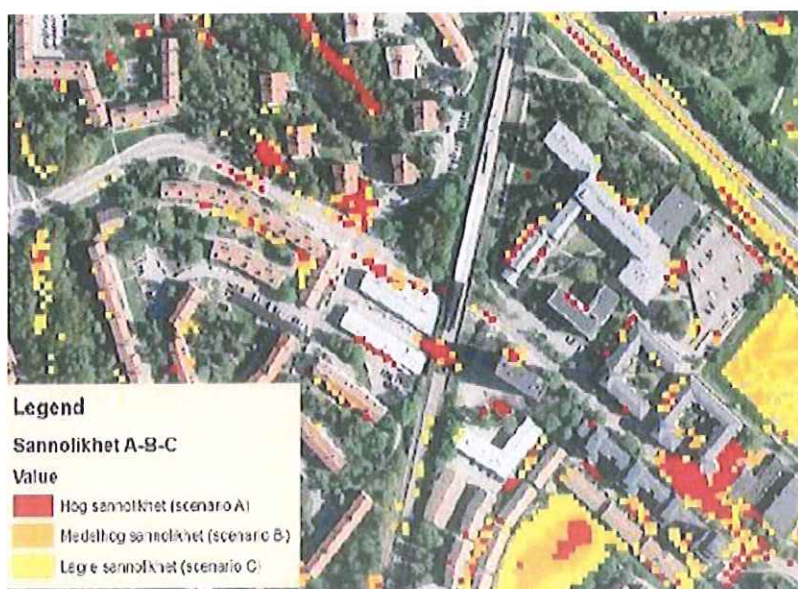
Skyfallskartläggning, Stockholm Vatten
