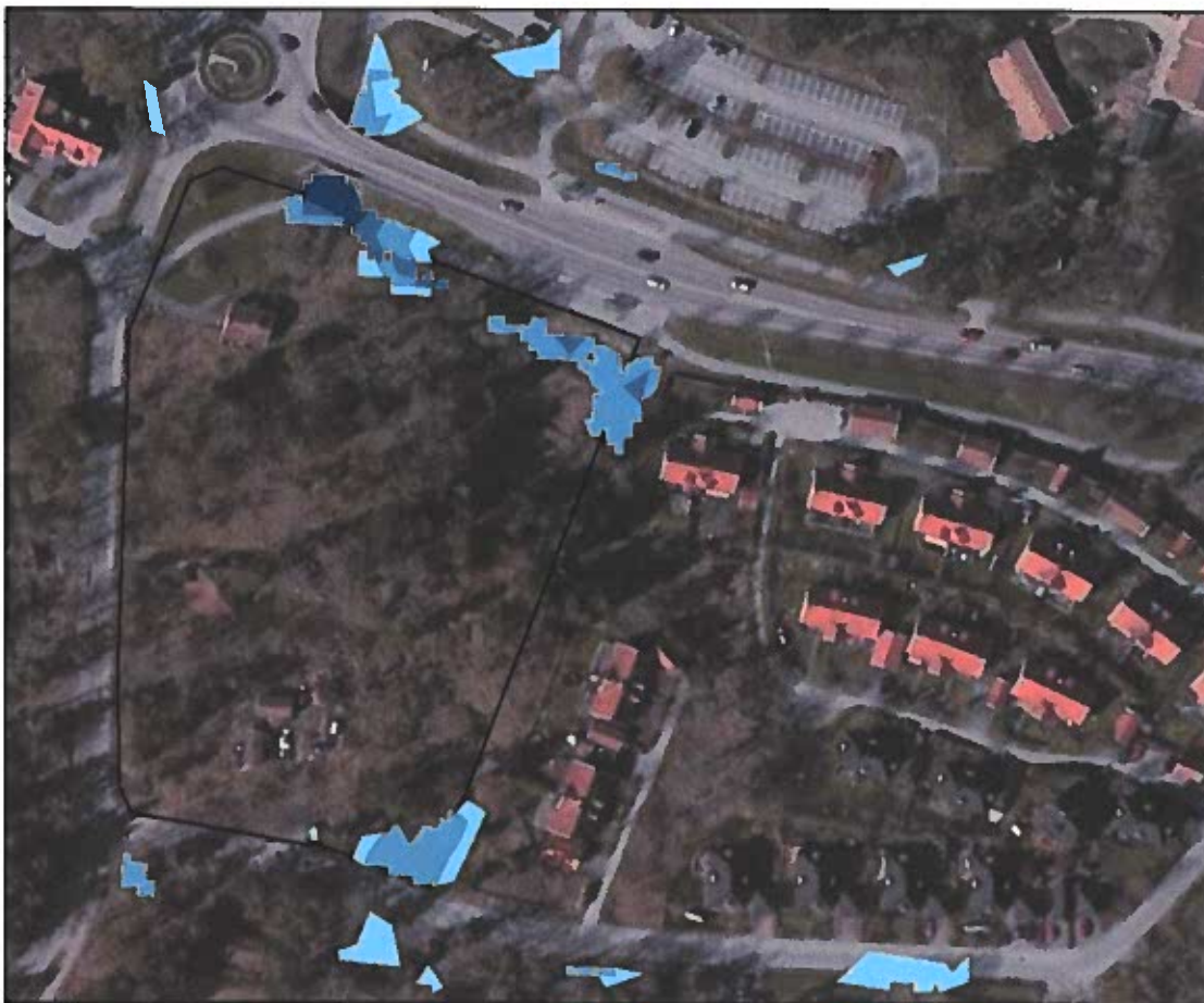
Figur 4-1. Lågpunktskartering utförd av Länsstyrelsen Stockholm. Planområdet är markerat med en svart polygon. © Länsstyrelsen.
