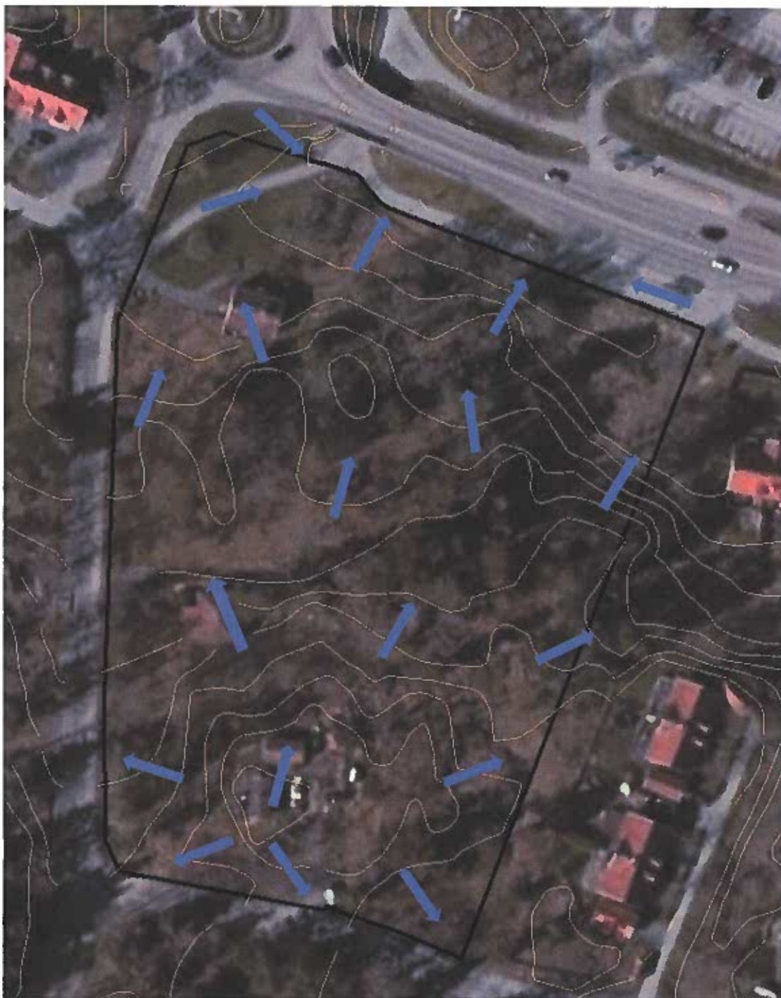
Figur 3-6. Översiktskarta över Apelvägen, där blå pilar visar naturliga flödesriktningar för avrinnande dagvatten.
