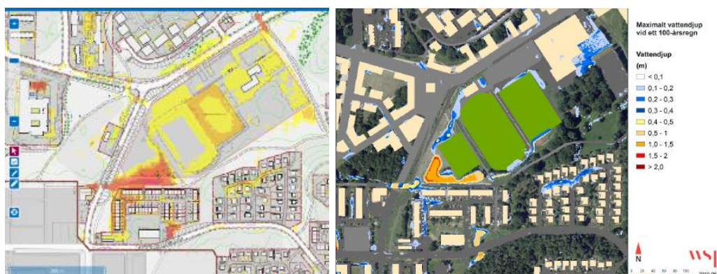
Figur 4. Stadens skyfallskartering som visar risken för översvämning vid Vårbergs IP och nedströms liggande bostäder i nuläge.
