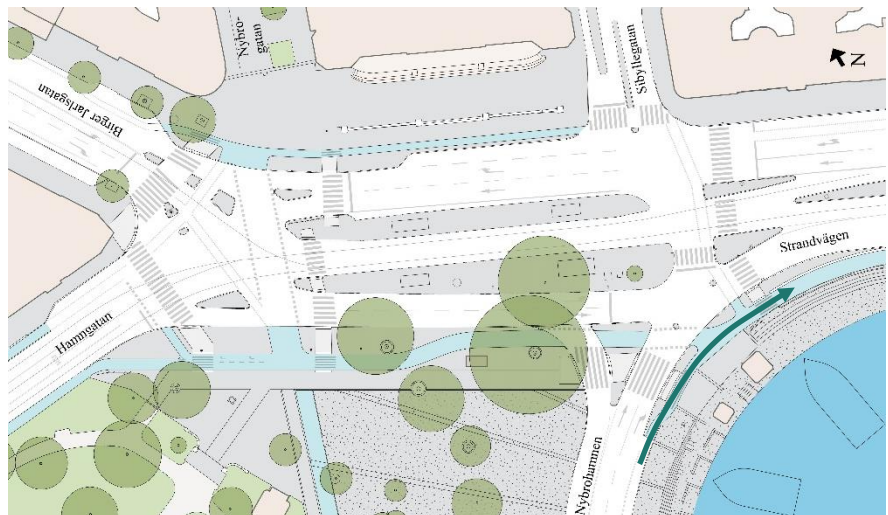
Figur 22. Ny cykelbana mellan Nybrohamnen och Strandvägen.
