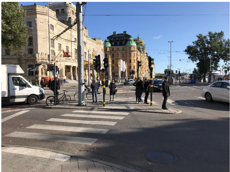
Figur 4. Tre övergångsställen leder till refugen där gående väntar på grönt ljus i signalslussen.
