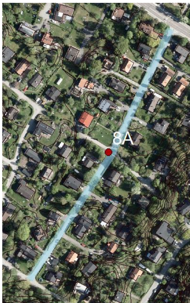
Figur 10. Avrinningsområde till makadammagasin längs Måsvägen.
