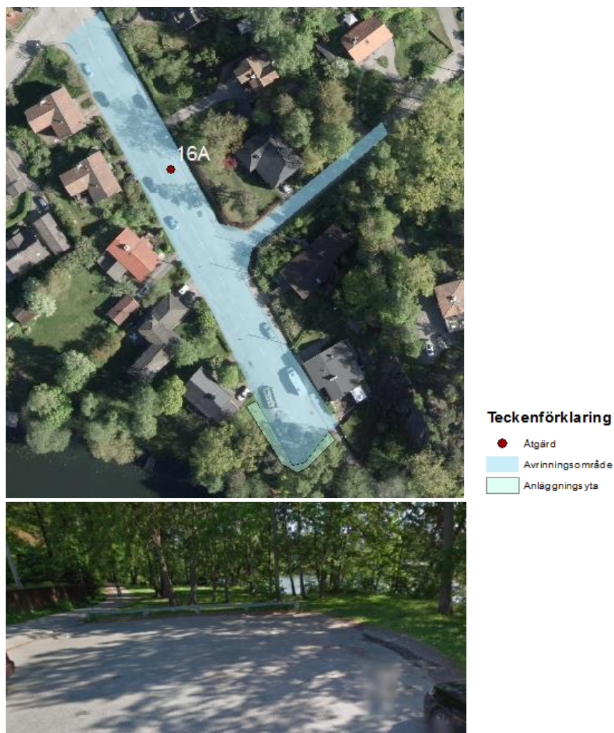
Figur 33. Avrinningsyta från Svartlösavägen som kan ledas till växtbäddar. Den nedre bilden visar förslag på placering av växtbädd i slutet av vägen.
