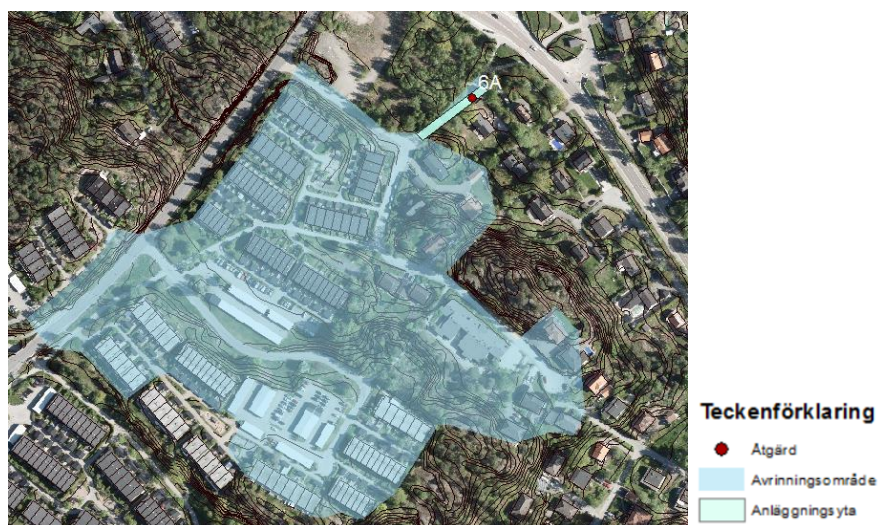
Figur 7. Avrinningsområde och anläggningsyta för avsättningsmagasin i Furuvägen.
