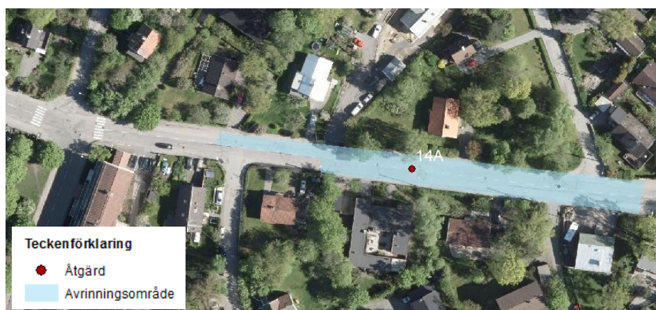
Figur 25. Avrinningsområde till nedsänkta växtbäddar på båda sidor av Långbrodalsvägen.
