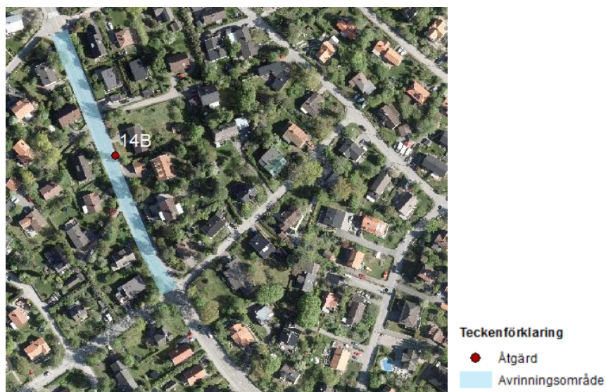
Figur 26. Avrinningsområde till nedsänkta växtbäddar på båda sidor av Herrängsvägen.
