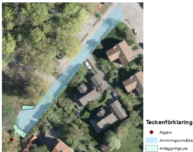
Figur 19. Nedsänkt växtbädd vid vändzon, Strandängsvägen.
