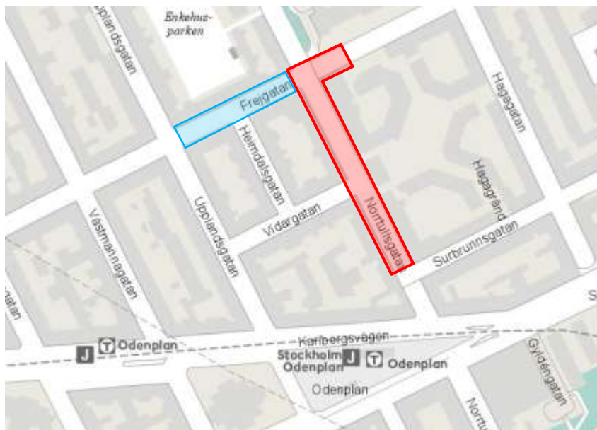
Bild 1 Projektets avgränsning. Röd figur visar större åtgärder i form av breddad gångbana och renoverad platsbildning. Blå figur visar enklare åtgärd i form av ändrad parkeringslösning.
