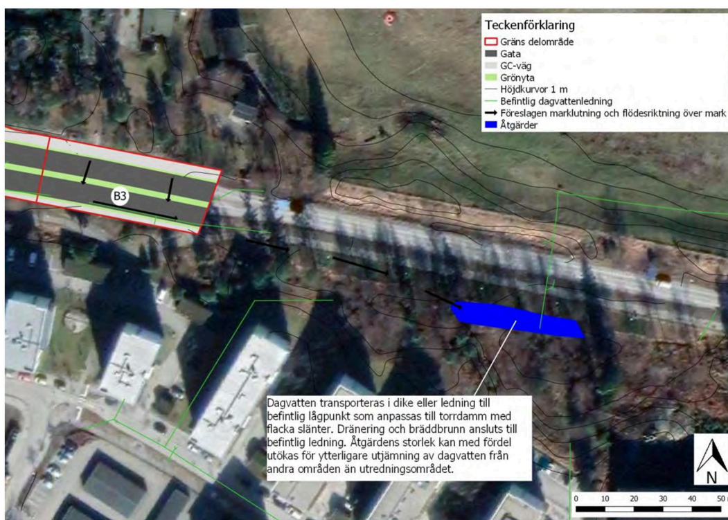
Figur 16. Övergripande dagvattenhantering med föreslagna åtgärder för fördröjning och rening inom delområde B3. Observera att åtgärdsytan är ungefärlig och utritad i illustrativt syfte. Bakgrund från Google (Google maps, u.å.).
