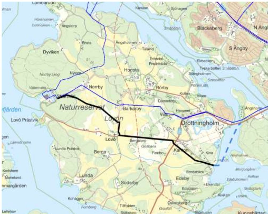
Figur 1. Befintliga ledningsstråk (blå heldragen linje) och förordat alternativ på ny huvudvattenledning (svart linje). Pågående projekt i Drottningholmssundet (blå streckad linje)
