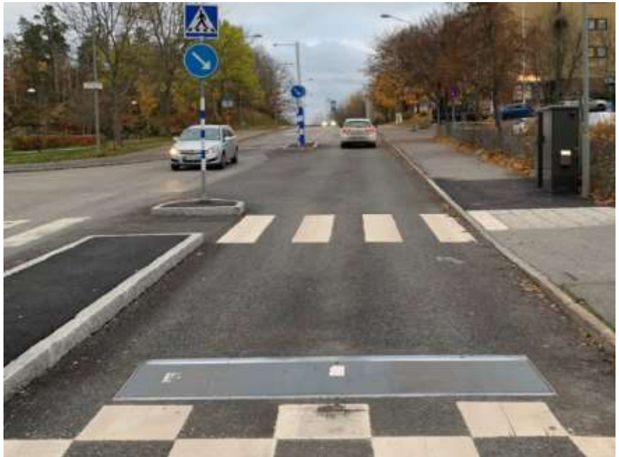
Figur 6, Dynamiskt farthinder på Vårholmsbackarna.
