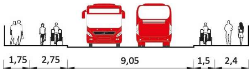
Figur 6. Befintlig sektion Skansbrogatan
