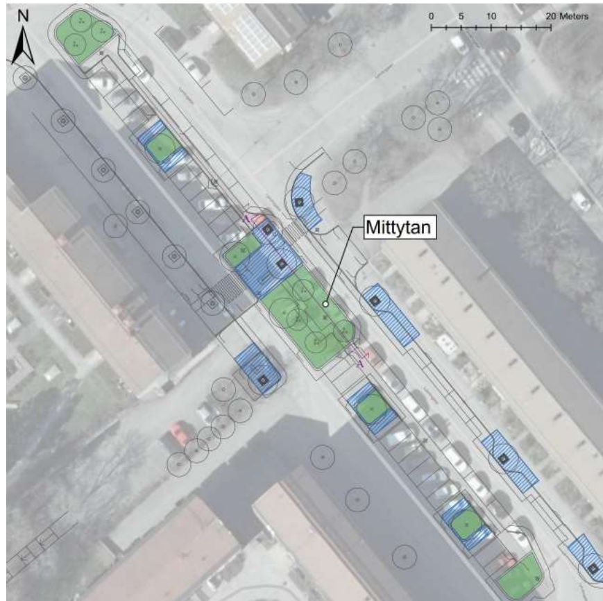
Fig 10. Illustration av växtbäddar. Gröna ytor är öppna växtbäddar med planteringar dit vattnet rinner genom öppningar i kantsten och de med blå skraffering är ytor med skelettjord som vattnet rinner in i växtbäddarna via brunnar.
