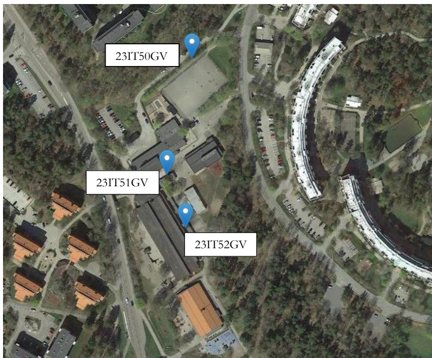
Figur 2. Satellitfoto över Njukärrens skola. Blåa markeringar visar placering av grundvattenrör.
