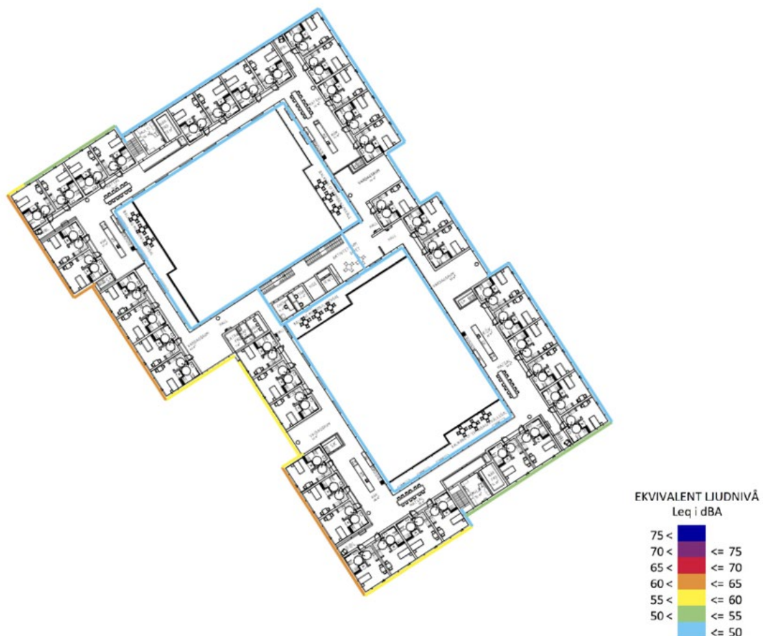
Figur 24: Planlösning över normalplan där den högsta ekvivalenta ljudnivå i fasad är redovisad. Fasad som är markerad med orange och gul färg vänder sig mot Tyresövägen. Trafikbullerutredning vård- och omsorgsboende Tyresö Strand, Efterklang: part of AFRY, 2023-12-04.
