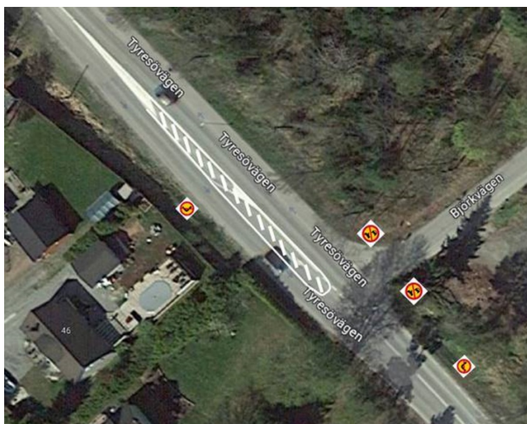
Figur 5: Borttagning av vänstersväng vid förlängning av spårrområde och skyltning som planeras under våren 2024.
