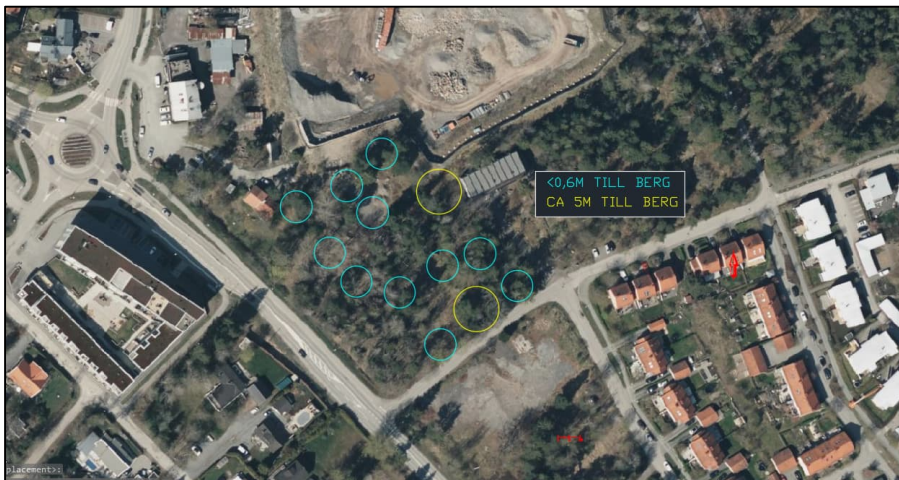
Figur 5 Ungefärlig bedömd lokalisering av lersvackor från utförd geoteknisk undersökning. Vid gula cirklar ökar jorddjupen upp till ca 5m. I mitten av cyanfärgade cirklar påträffas berg som djupast 0,6m under befintlig marknivå.
