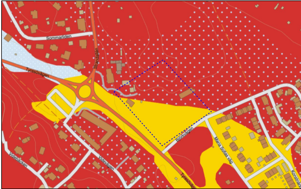
Figur 2 Urklipp från SGUs jordartskarta. Rött indikerar ytnära berg. Rött m. ljusblå prickar indikerar ställvis tunt lager morän på berg. Gul indikerar lera. Figur hämtad från www.sgu.se den 2023-11-27.
