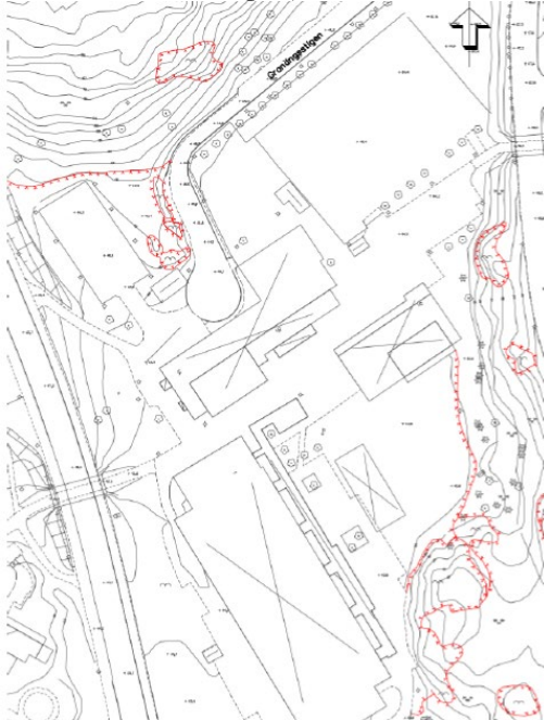
Figur 24. Inmätningar av partier med berg i dagen inom och i närheten av skolområdet.
