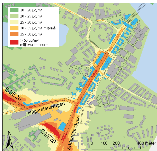
Beräknad dygnsmedelhalt av partiklar, PM10 ( \mu\text{g}/\text{m}^3 ), 36:e högsta dygnsvärdet år 2040 efter genomfört planförslag längs Södertäljevägen. Halterna gäller 2 m ovan gatunivå för ett normalt meteorologiskt år. Överskridande av miljö kvalitetsnormen inom programområdet på korta sträckor mitt på körbanan på Södertäljevägen. Illustration SLB-Analys
