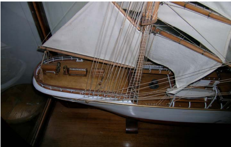
På samma modell ser man hur poopdäck längst akterut såg ut. Idag är det svart av tjära men kan enkelt slipas och behandlas. Ett nytt plåtdäck utförs bara på huvuddäck. Observera kobryggan mellan detta däck och signalhytten
