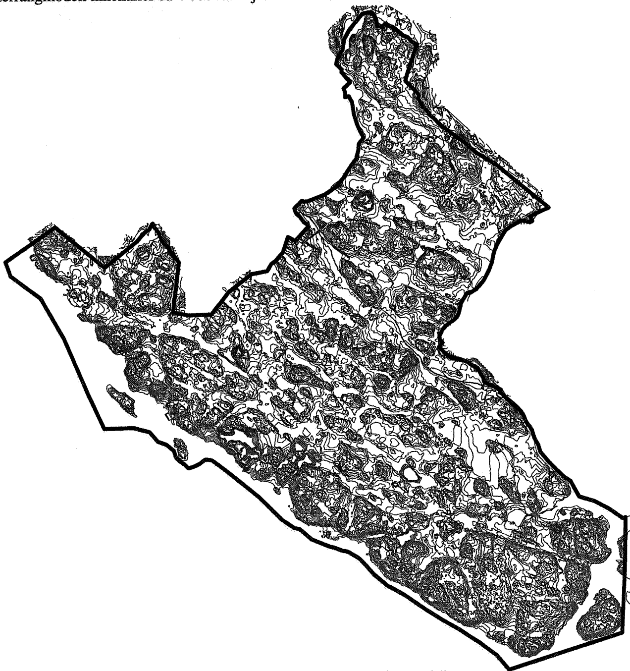
Figur 2. Terrängmodell efter triangulering och skapande av ny isolinjemodell
