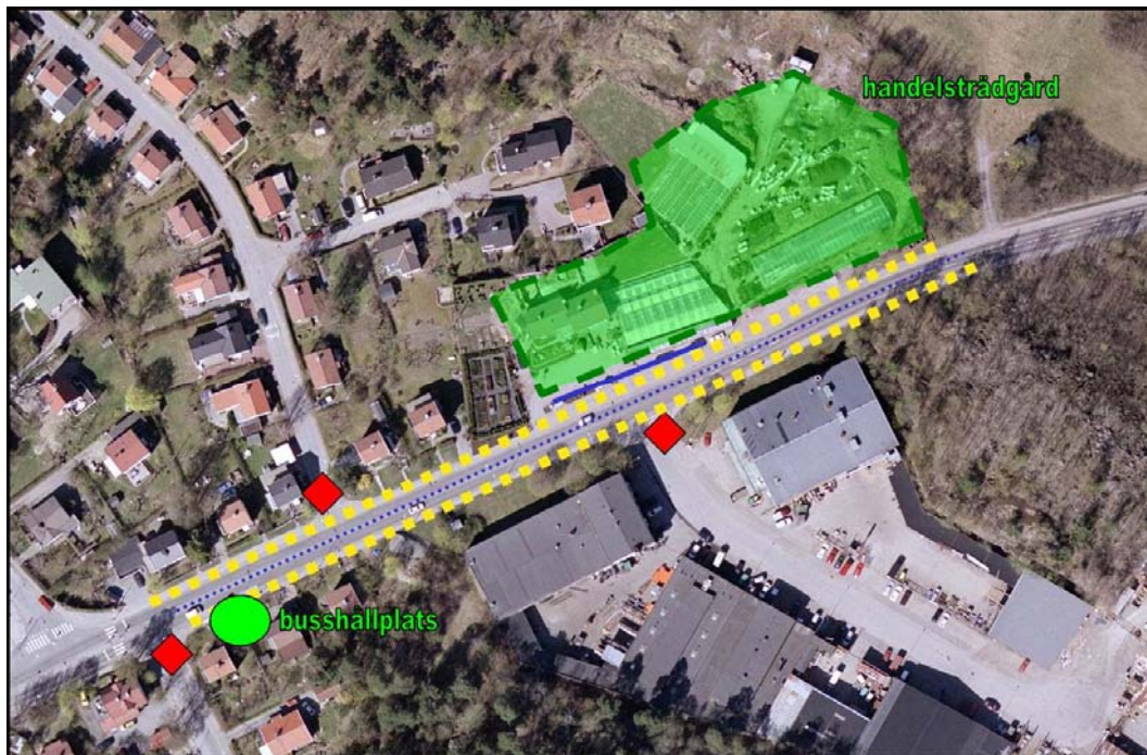
Foto 2: Flygfoto över sträckan. Röda romber markerar upphöjda cykelöverfarter. Gul streckad linje markerar cykelbanor. Blå tunn prickad linje markerar överkörningsbar mittrefug. Blått rakt streck markerar ny mur mot gångbana.
