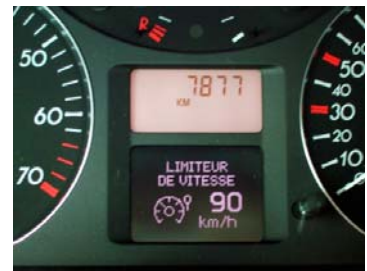
Fordonsintegrerad ISA (Renault prototyp)
