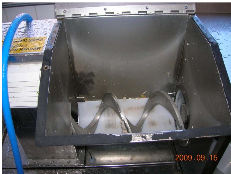
Skruv i inkastet på Sampro KV 200 S i S:t Eriks gymnasium
