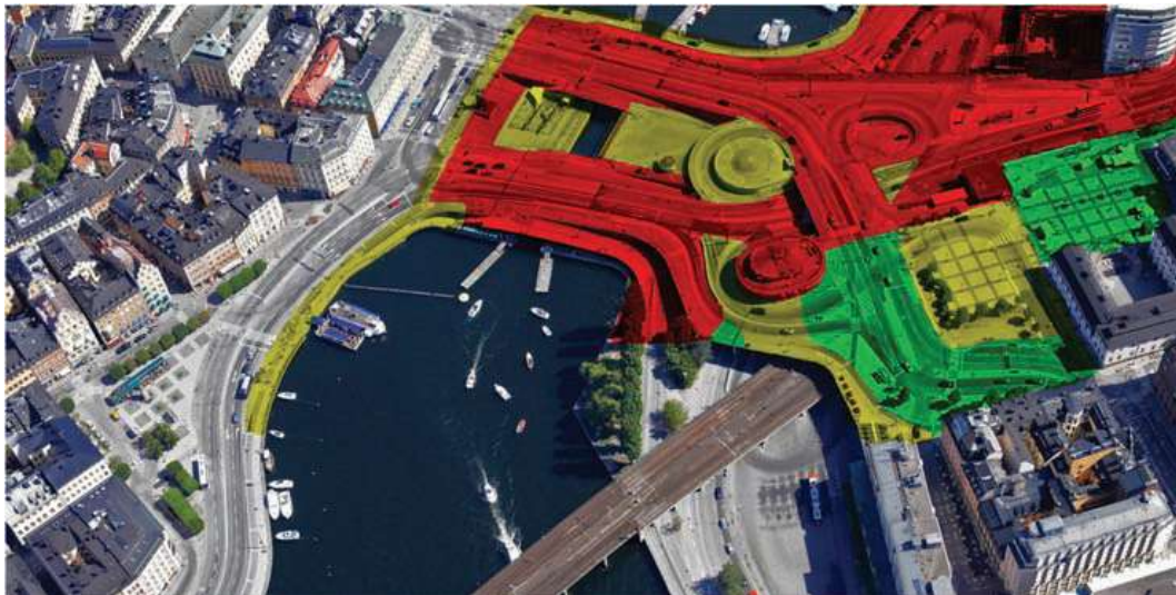
Figur 1. Bild över Slussen med Gamla stan till vänster och Södermalm till höger i bilden. Färgade ytor visar teknisk livslängd av Slussenanläggningen. Gröna ytor har en livslängd på 80 år, gula ytor har en livslängd på upp till 30 år och röda ytor måste byggas om snarast. ©: Stockholms stad.
