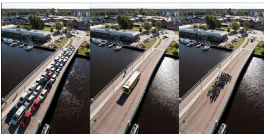
Illustration av transporteffektiviteten mellan olika trafikslag. Bilden visar utrymme som krävs för att förflytta samma antal människor med bil (till vänster), buss (i mitten) samt med cykel (till höger). Foto: Gävle kommun
