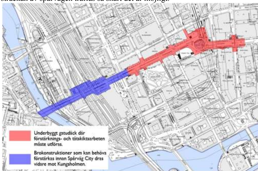
Fig 1 Projektområde. Rödmarkerat är område för tätskiktsbyte och förstärkning. Blått är område som kan behöva åtgärdas vid en förlängning av Spårväg City till Kungsholmen.
