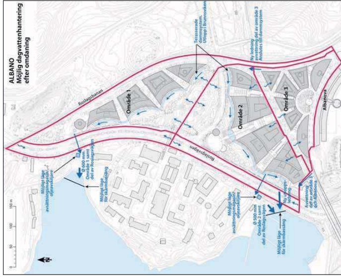
Figur 5.6.1 Möjlig dagvattenhantering efter ombyggnad av planområdet. Områdets delavrinningsområden förändras efter exploatering på grund av överdräckningen av Vårslödan. Det södra delavrinningsområdet delas därmed upp i två, ett större nor om-spåret och ett mindre söder om.
