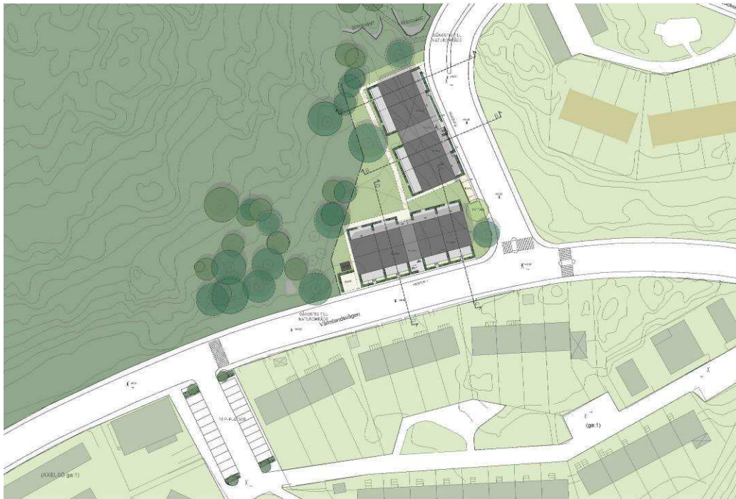
Delområde 1: Illustrationsplan (Brunnberg&Forshed arkitektkontor). En bostadslänga förläggs mot Värmlandsvägen respektive Rottnerosbacken. Befintlig parkeringsyta söder om Värmlandsvägen kan med ny utformning rymma 23 p-platser.
