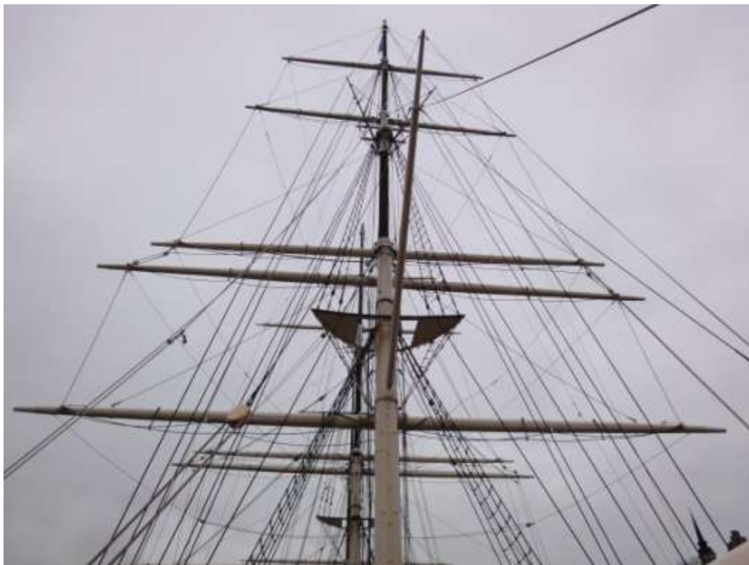
Del av riggen på af Chapman. Nedre delen av masterna är av stål, de båda övre av trä
