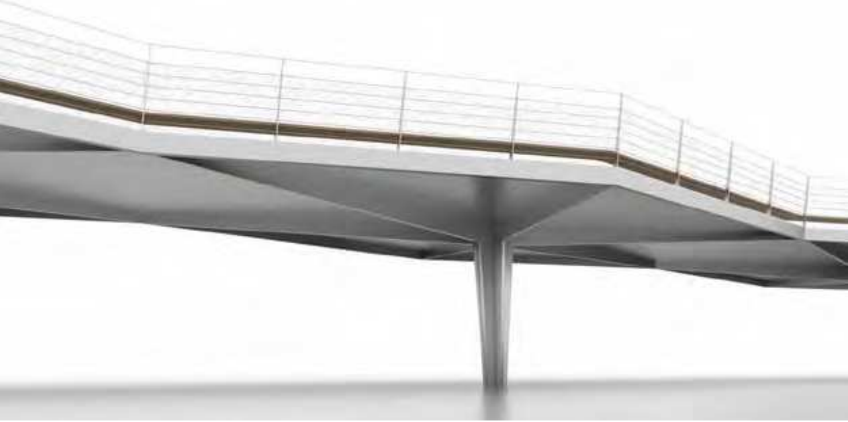
Del av Albanobron underifrån, konstruktionsprincipen är tydligt gestaltad genom pelarstöd och synliga balkar.
