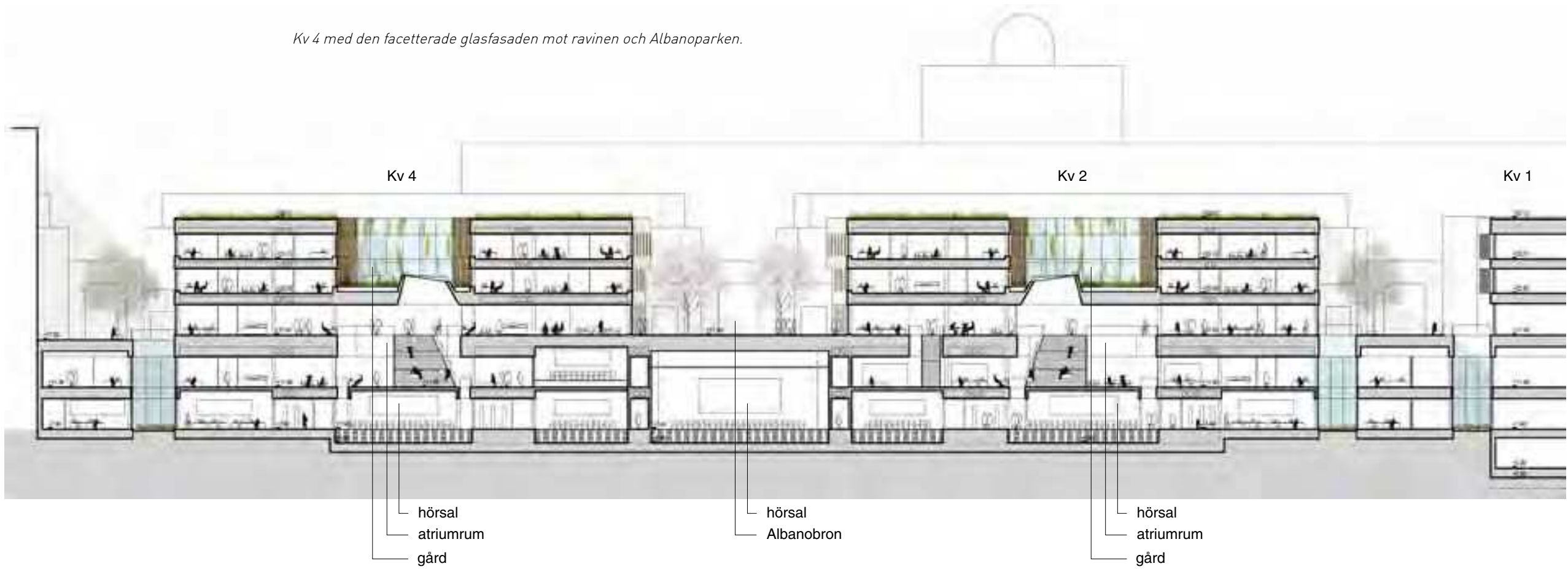
Sektion F-F genom atriumrum i kv 2 och 4, 1:500
