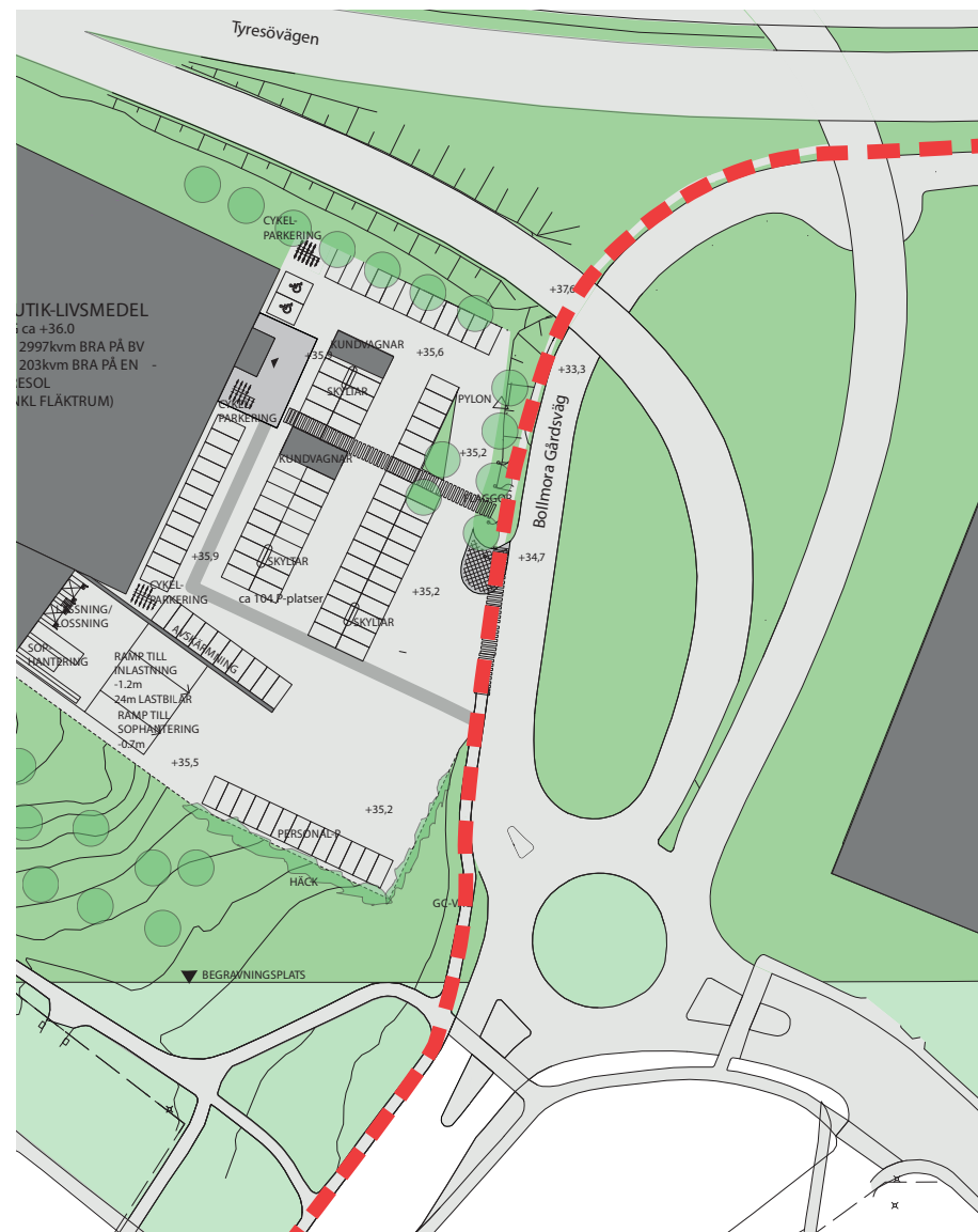
Illustration av planerad gång- och cykelvägs sträckning längs Njupkärrsvägen och Bollmora Gårdsväg.
