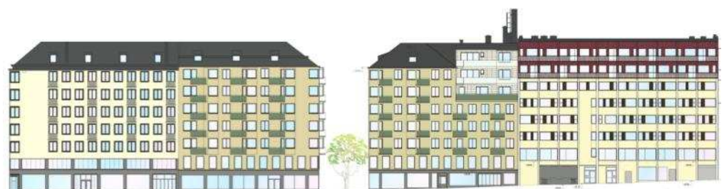
Fasad mot norr/Odengatan och torget med handelsytor i två plan och fasad mot väst/Vegagatan med nya takpåbyggnader. (Illustrationer: Equator European Architects)
