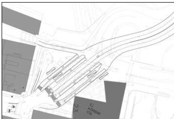
Figur 16 Bussterminal för stadsbussar på Södermalmstorg enl. alternativ B (se PM "Projekt Slussen. Trafik i nord-sydlig riktning under Etapp 1 juli 2014 - december 2017.")
