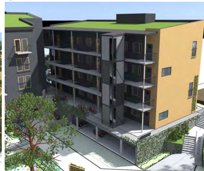
Hus C med entrébalkong och utrymningstrapphus
