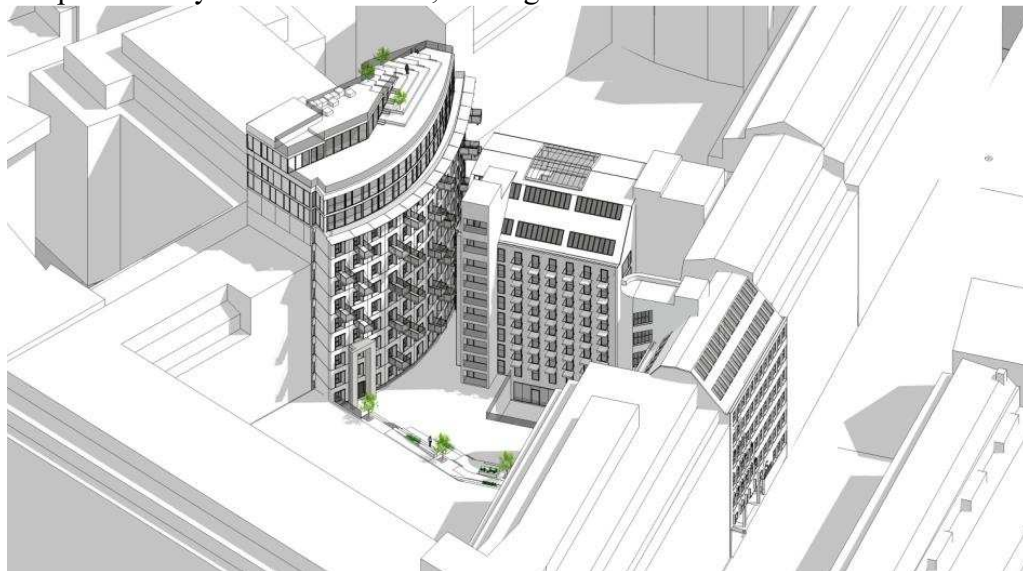
Blåstern 14 efter planens genomförande, med balkonger, påbyggnad och restaurerad fasad. Sett från nordväst.
