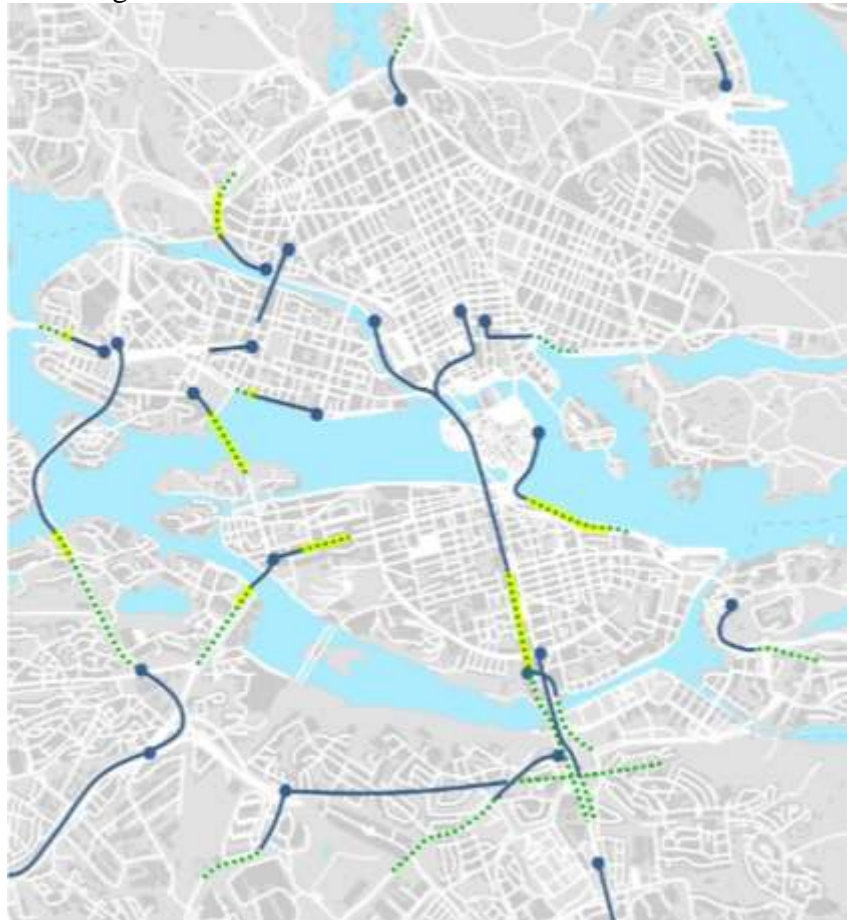
Figur 6: Förändring av köer vid viktiga flaskhalsar, förmiddag 2020. Gröna prickade linjer = köer som försvinner med scenario C, blå = köer som blir kvar. Gröna prickiga med gul bakgrund = skillnad mellan scenario B och C.
